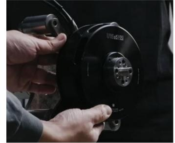
FIG 4-1-1 Install motor
